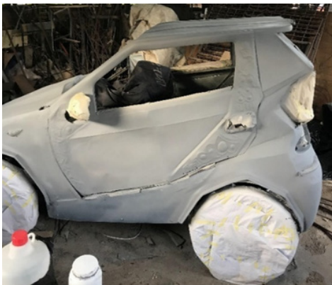
Fig 62: A second coat of primer
